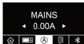
Nastavení proudového rozhraní síťové sběrnice
